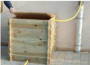
Le principe du récupérateur est d'**acheminer l'eau du toit vers une cuve correctement dimensionnée** afin de répondre aux besoins en eau. Un dispositif de collecte d'eau est mis en place sur la descente de gouttière et permet d'acheminer l'eau à la cuve. Le récupérateur est installé à l'extérieur et peut être enterré.
